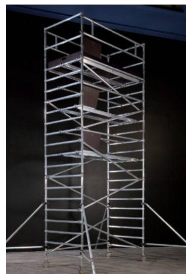
ハッチ式プラットフォームですので内側昇降が可能となり安全です。最上階には巾木が標準装備です。
